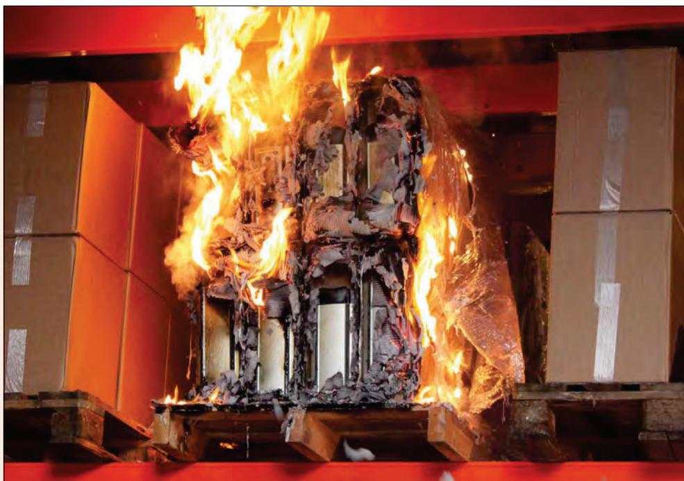
Brandversuch mit kartonierten Lithium-Ionen-Akkus (Foto: VdS)
